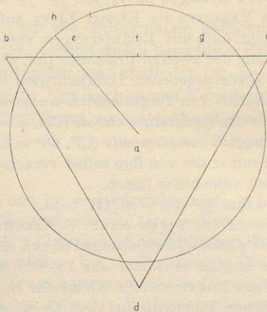
Fig. 1: Ausrundung eines gleichseitigen Dreiecks in den umfangsgleichen Kreis
