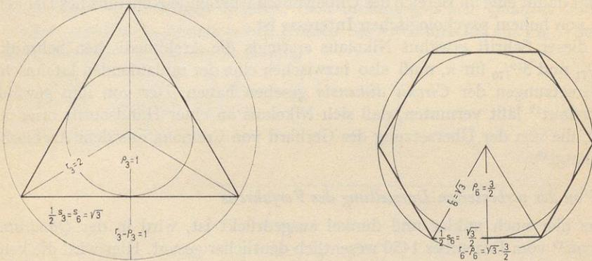
Fig. 2: Zur Bestimmung des isoperimetrischen Halbmessers aus einem gleichseitigen Dreieck und dem umfangsgleichen regelmäßigen Sechseck
