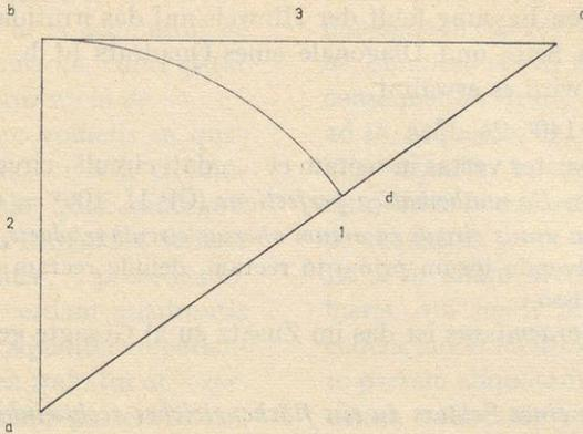
Fig. 24: Zur Verwandlung eines Kreissektors in ein flächengleiches rechtwinkliges Dreieck
