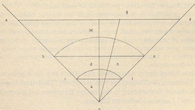
Fig. 21: Ausstreckung eines Kreisbogens (CP II, fol. 106<sup>r-v</sup>)
