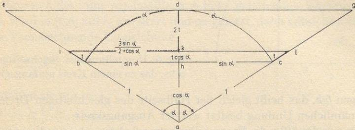
Fig. 7: Ausgleichsverfahren zur Streckung eines Bogens
