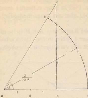
Fig. 6: Herstellung des gleichseitigen Dreiecks, das zu einem Kreis umfangsgleich ist
